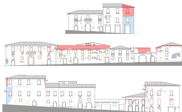
Figura 7. Rilievo dello stato di danno riportato da alcune porzioni dell'aggregato in esame.
