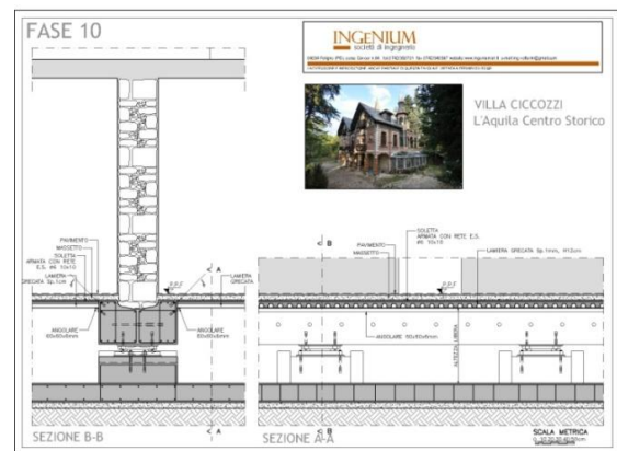
Figure 19-20-21-22. Fasi dell'intervento per l'applicazione dell'isolamento sismico
