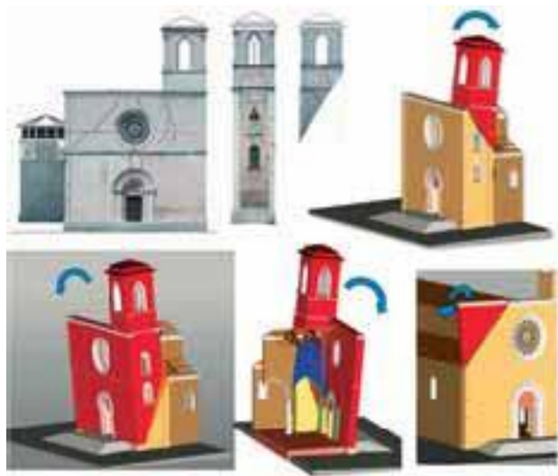
Figura 3. Principali meccanismi di collasso in corrispondenza della facciata e campanile
