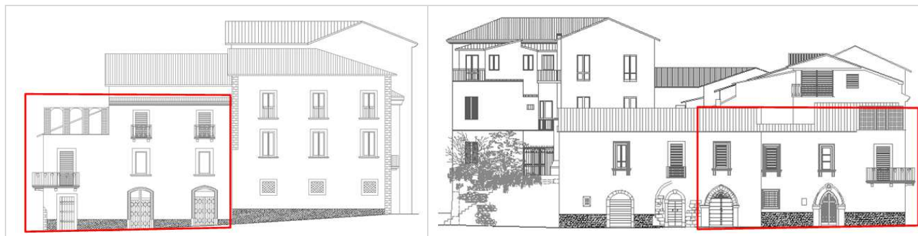
Esempi di serramenti in legno presenti nell'unità strutturale
