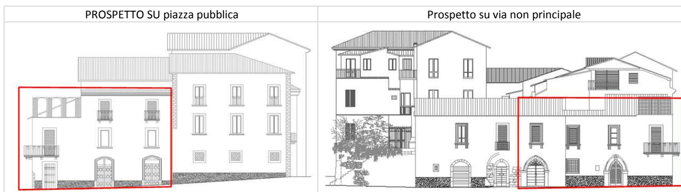
Esempi di serramenti in legno presenti nell'unità strutturale
